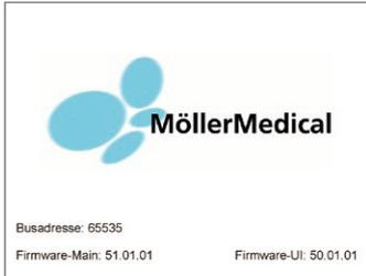
Nach Einschalten der Netzspannung erscheint zunächst für 6 Sekunden eine Bootsequenz (Abb. 4) mit relevanten Informationen. Dort werden die vorhandene Softwareversion des Mainboards (Firmware-Main), die Softwareversion der Bedieneinheit (Firmware-UI) sowie die Gerätebusadresse auf dem Display angezeigt (Abb. 4). Während des Startens führt die Steuerung einen Selbsttest durch, wobei auch der interne Barcodescanner kurzzeitig angeschaltet wird.
