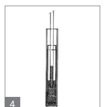
4. Pipete el filtrado (fig. 4) tan pronto como sea posible una vez haya finalizado la centrifugación, pues este volverá a difundirse lentamente en el concentrado.
