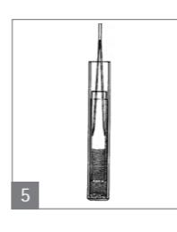
5. Oder zur Konzentratentnahme Schwimmer mit gespreizter Pinzette herausziehen (Abb. 5).
