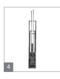
4. Filtrat möglichst bald nach Beendigung der Filtration herauspipettieren (Abb. 4), sonst Gefahr der Rückdiffusion.
