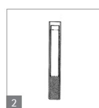
2. Schwimmer mit Membran nach unten wieder in das Zentrifugenröhren hineingleiten und ca. 5 Minuten stehen lassen, so dass die Membran von der Probe benetzt wird (Abb. 2). Ausnahme: bei Filtration von nicht koaguliertem Blut vor dem Einführen des Schwimmers ca. 2 Minuten vorzentrifugieren, um Hämolyse zu vermeiden. Für die Zentrifugation Verschlussklappe nicht wieder aufsetzen.
