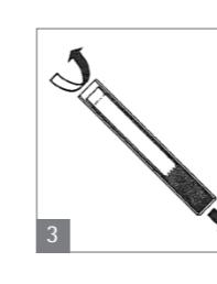
3. Effectuer la centrifugation avec une centrifugeuse de laboratoire acceptant des tubes jusqu'à 17×100 mm. (Fig. 3). Force centrifuge relative maximale : 2 500 g pour les rotors à tête oscillante ; 2 000 g pour les rotors à tête angulaire (voir le graphique).
