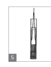
5. Ou retirer le flotteur avec des pinceuses ouvertes pour accéder au concentrat (Fig. 5).
