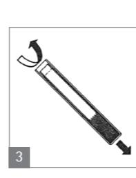
3. In einer Laborzentrifuge für maximal 17×100 mm Röhrchen (Abb. 3) zentrifugieren. Maximale relative Zentrifugalbeschleunigung: 2,500 g bei Ausschwingrotoren, 2,000 g bei Winkelrotoren (siehe Diagramm). Bei konzentrierten Proteinlösungen, z.B. Serum oder Blut, zu Beginn 5 Minuten bei halber Maximaldrehzahl zentrifugieren. Bei lipoidehaltigen Lösungen, z.B. Milch, nur mit Winkelkopfrotoren zentrifugieren.
